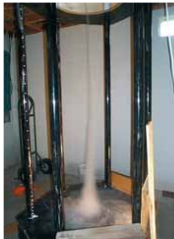
6. A: tværsnit af en Perdue tornado-generator der ofte er blevet anvendt i laboratorier til at frembringe tornado-lignende hvirvler. B: en hvirvel frembragt af en privat person i en lignende anordning.
